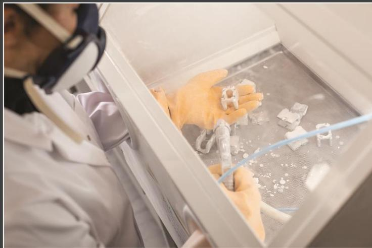
Entfernen von überschüssigem Pulver
