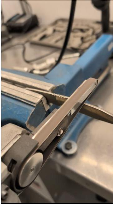
2. Entfernen der Stützstrukturen
